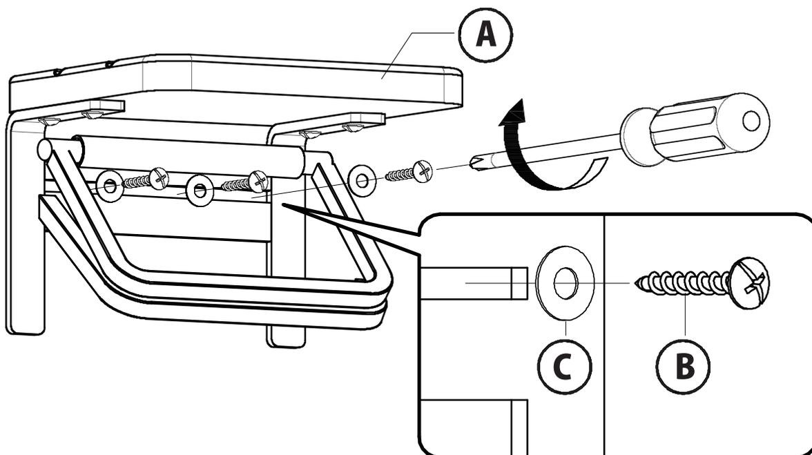
本体のすき間部分に、C.ワッシャーを通したB.ネジ（両端2箇所・中央1箇所）を取り付けます。
